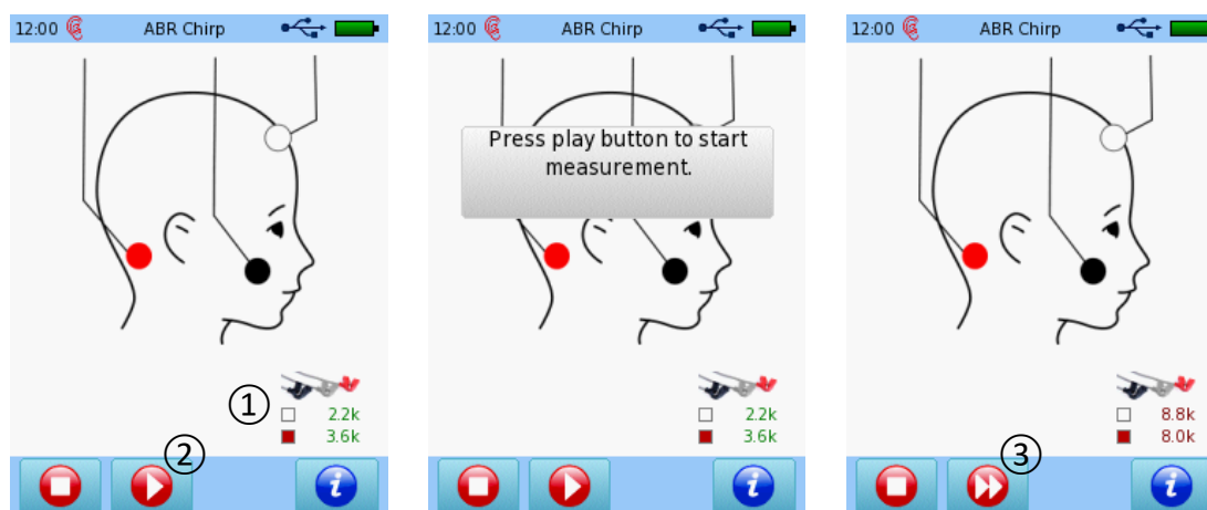
Рисунок 47: Измерение импеданса ABR (слева: нормальные значения импеданса и кнопка "play"; в центре: нормальные значения импеданса и кнопка "play", а также напоминание о необходимости начать тест, нажав на кнопку "play"; справа: неудовлетворительные значения импеданса с кнопкой "forward")
