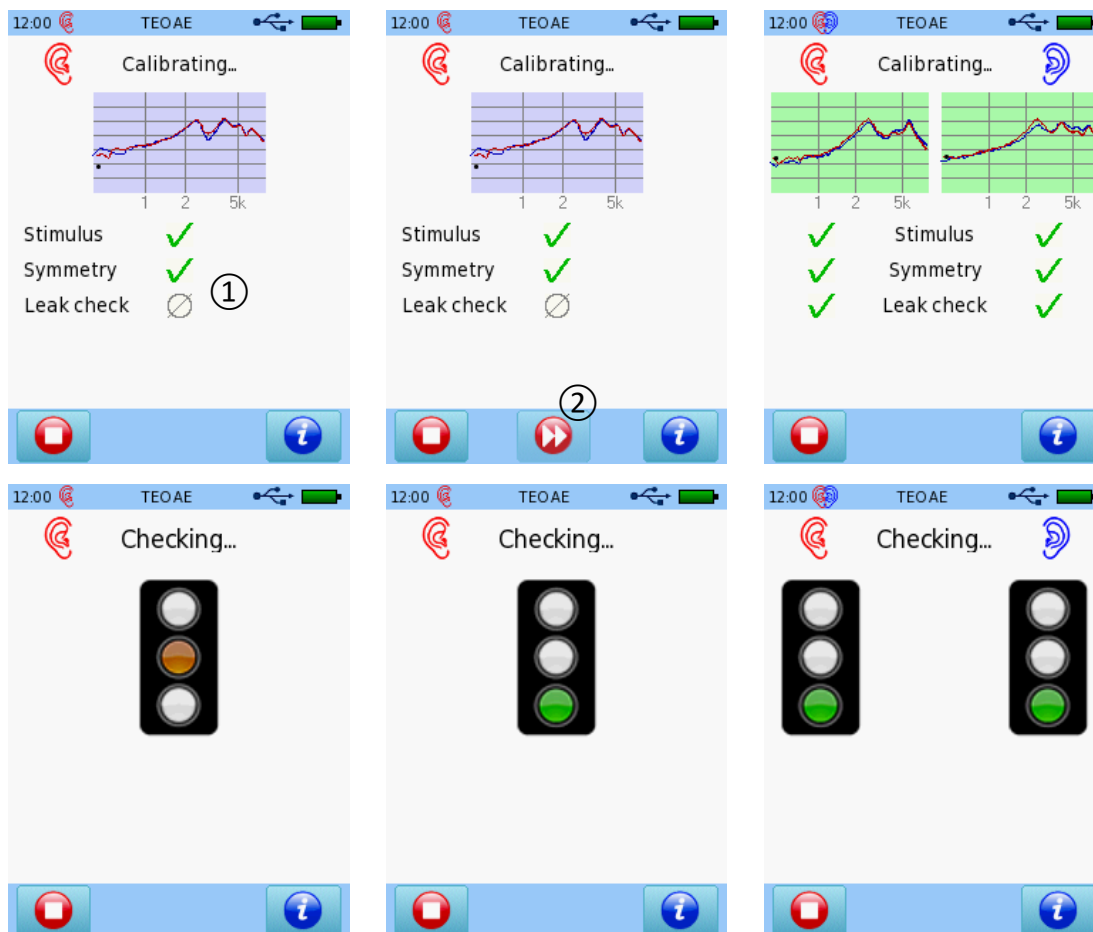
Рисунок 30: Калибровка ушного зонда для TEOAE (вверху слева: моноaurальный режим expert; вверху в центре: моноaurальный режим expert с опцией "пропустить"; вверху справа: бинауральный режим expert; внизу слева/в центре: моноaurальный режим simple; внизу справа: бинауральный режим simple)
